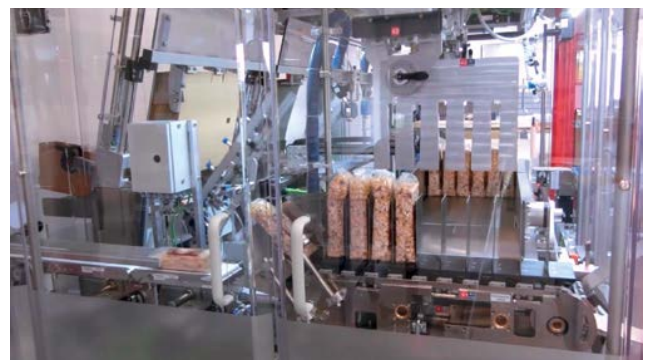
Reale Maschine läuft mit dem im Vorfeld in der Simulation getestetem SPS-Programm
